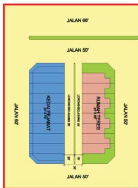
Rajah PD1 (iv) Lorong Belakang Bagi Bangunan Kedai Teres Membelakangi Rumah
