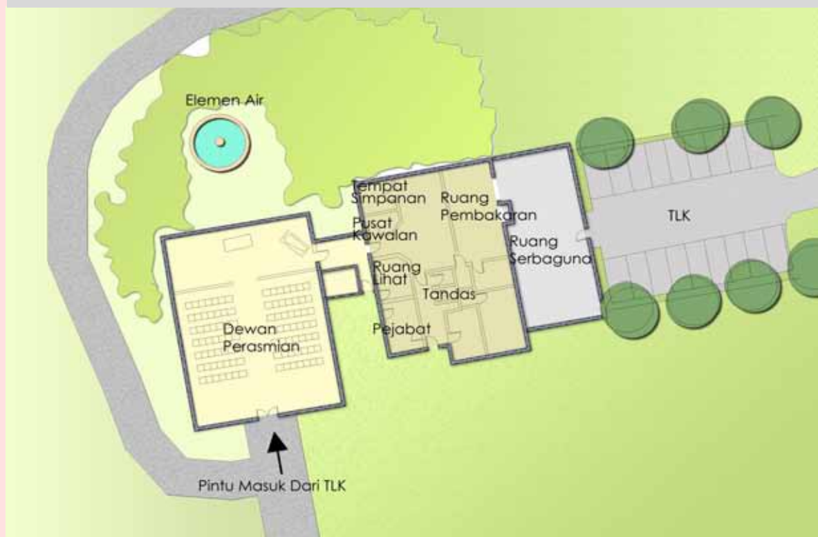
Rajah KM 5-1(ii): Contoh Pelan Tipikal Susunatur Krematorium
